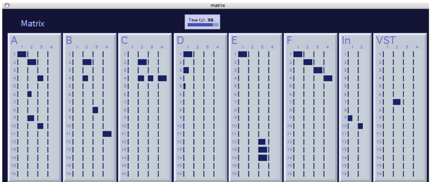
Chaque matrice permet de diriger les signaux des modules d'entrées (A à F, In et VST) vers le module de sorties (Master). Le niveau des envois s'ajuste à la souris.
